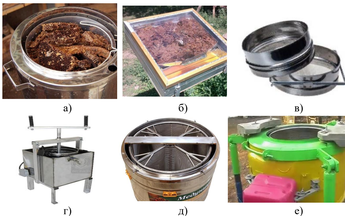
а) – паровая воскотопка; б) – солнечная воскотопка, в) – фильтр, г) – воскопресс с подогревом, д) – воскотопка паровая центробежная, е) – центрифуга для отжима воска из мервы
